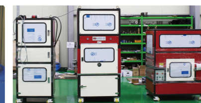
폐필터 처리장치 (Waste Filter Treatment System)
